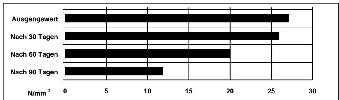
**Ermüdungsversuch auf Zugscherverbindungen (DIN 53285)**
