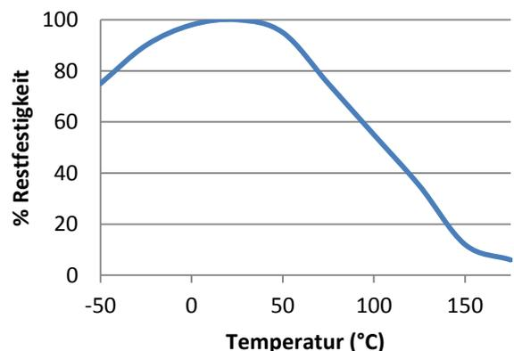
„Hitzebeständige“ Scherfestigkeitsversuche wurden auf Weichstahl durchgeführt. Aushärtung bei Raumtemperatur über 24 Stunden. Vor den Testversuchen wurden die Teile über 30 Minuten auf der Testtemperatur gehalten.
